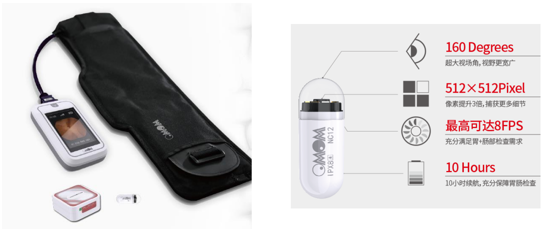
图 2-19：金山科技 NC100 胶囊式内窥镜系统
